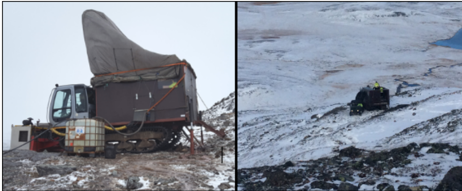
Figur 1. Vintersäkrad borrhigg. Mineraliserad berghäll vid Burfjord.
